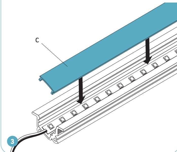
Insérer l'extrusion de manière bien serrée dans la rainure de montage de  $\frac{3}{4}$ ". Effectuer les connexions électriques (pp.3-4).
