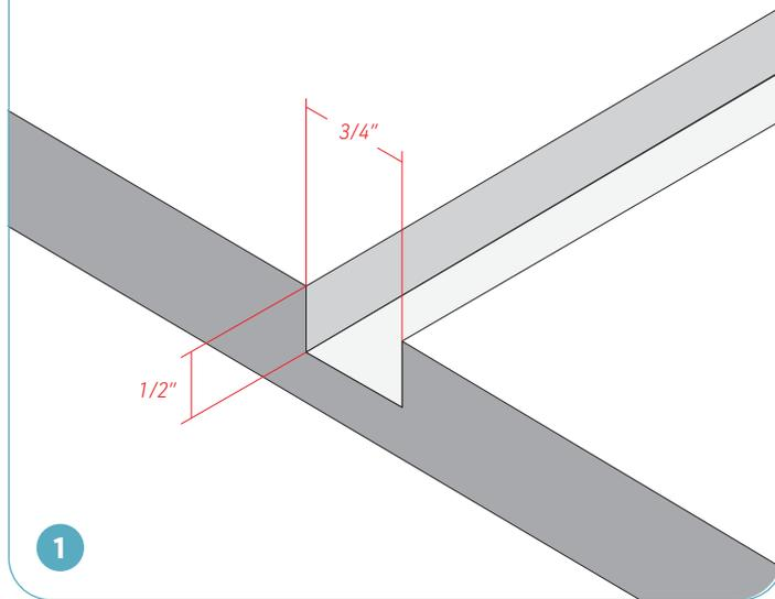
Insérer l'extrusion de manière bien serrée dans la rainure de montage de  $\frac{3}{4}$ ". Effectuer les connexions électriques (pp.3-4).
