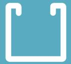
Découper une rainure d'une largeur de  $\frac{3}{4}$ " et d'une profondeur de  $\frac{1}{2}$ ".
