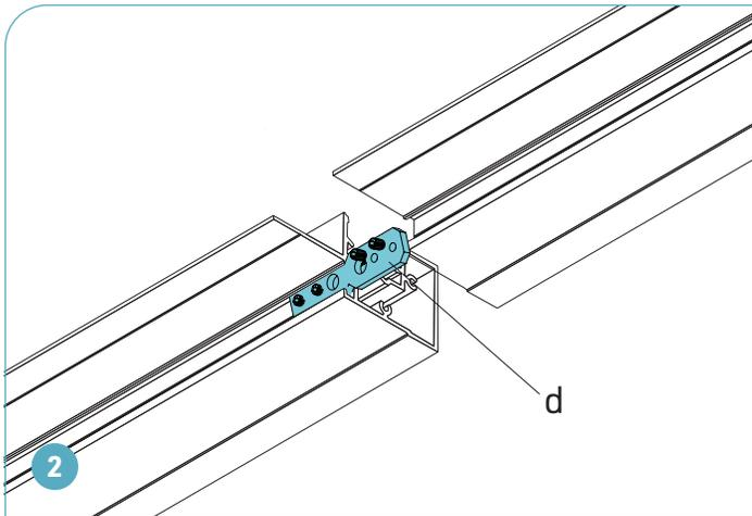
Si le luminaire est composé de plusieurs longueurs, les assembler à l'aide des équerres type B (d).
