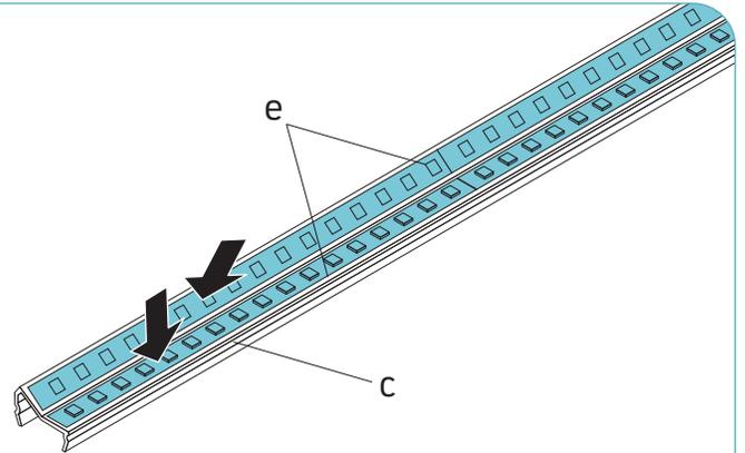
Clipser l'insert en PVC (c) avec les rubans DEL dans le profilé en aluminium dans la position désirée.
