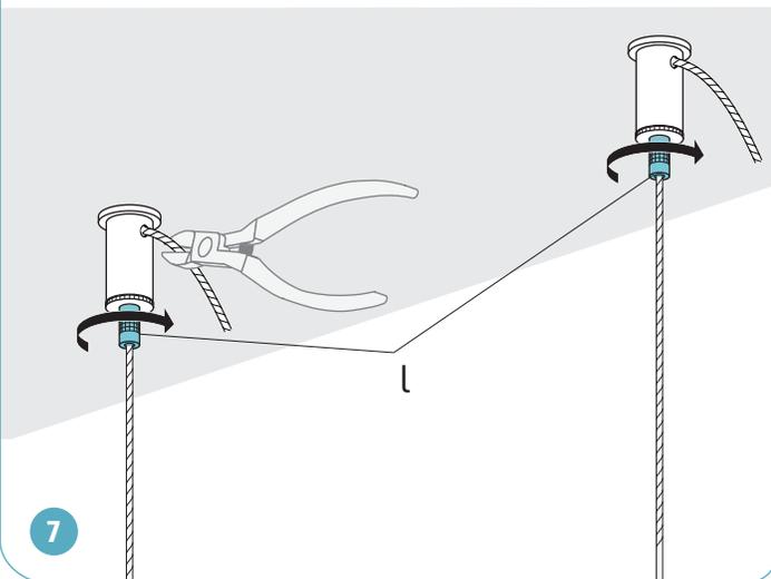
*Laisser le fil électrique plus long que les câbles de suspension. Le fil électrique doit être suffisamment long pour permettre la rotation du luminaire.*
