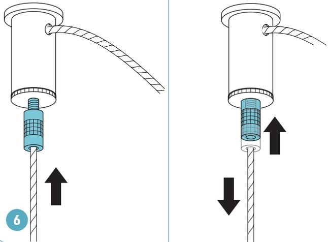
Resserrer les butées sur les fixations de câble (l). Couper l'excédent de câble.
