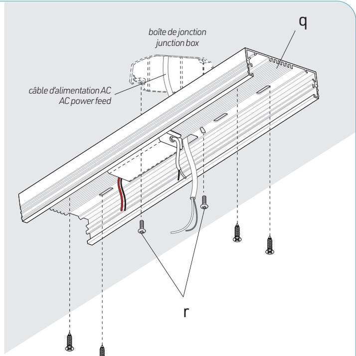
Effectuer les connexions électriques entre l'entré du transformateur (t) et le câble d'alimentation (voir le schéma de branchement p. 17).
