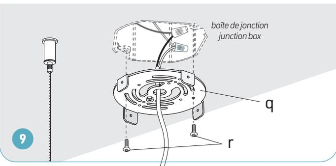
Visser la canopée (p) au support de montage (q) à l'aide des vis (s) fournies.
