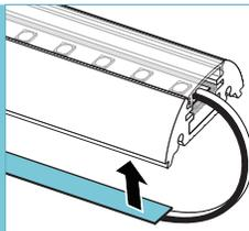
Faire passer le(s) fil(s) électrique(s) à travers le trou dans l'embout intérieur (e1) (**pour end feed**) ou à l'arrière de l'extrusion en utilisant la rainure dans l'embout intérieur (**pour back feed ou pour l'option HAUT/BAS avec les rubans DEL connectés**).
