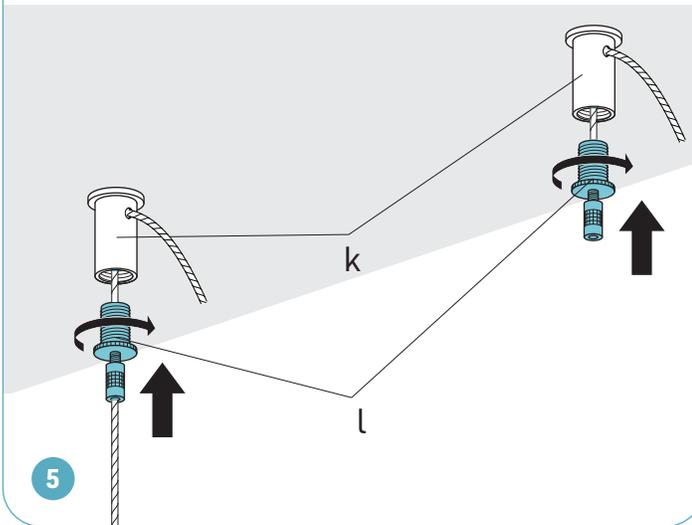
Ajuster la longueur des câbles de suspension: pour le raccourcir, pousser le câble vers le haut; pour l'allonger, appuyer sur la butée de câble et tirer le câble vers le bas.
