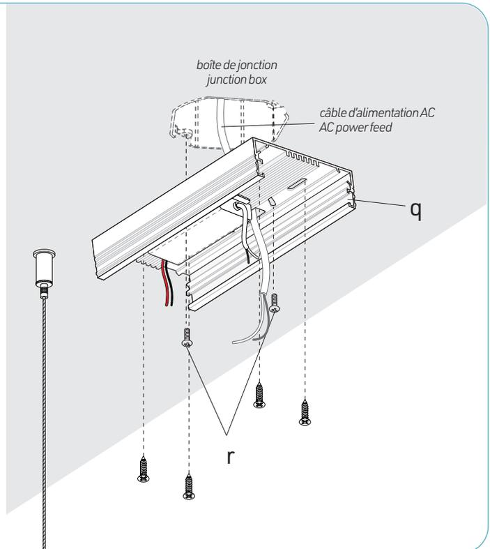
Effectuer les connexions électriques entre l'entré du transformateur (t) et le câble d'alimentation (voir le schéma de branchement p.12).
