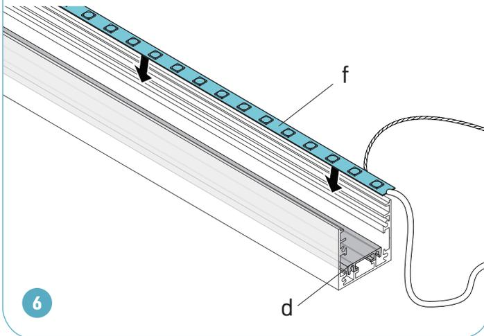
Faire passer le fil électrique du ruban LED à travers le trou dans l'extrusion.
