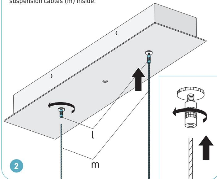
Ajuster la longueur des câbles de suspension: pour le raccourcir, pousser le câble vers le haut; pour l'allonger, appuyer sur la butée de câble et tirer le câble vers le bas.
