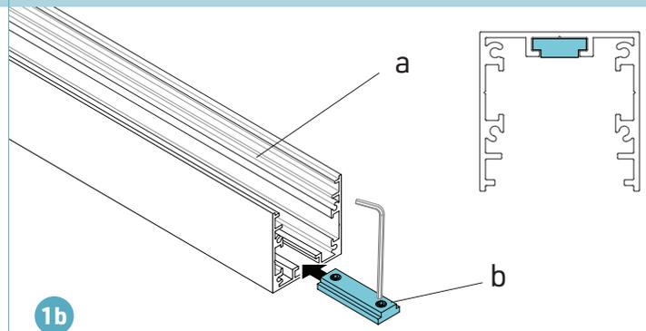
Si le profilé se compose de plusieurs longueurs, les connecter avec les équerrres droites (c) et les serrer avec vis de réglage fournies.
