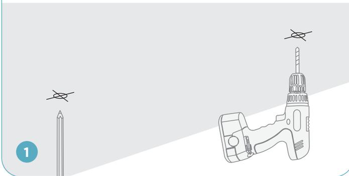
Installer les coupleurs de câble (k) au plafond. Utiliser des vis de montage #8 et des ancrages appropriés (non inclus).
