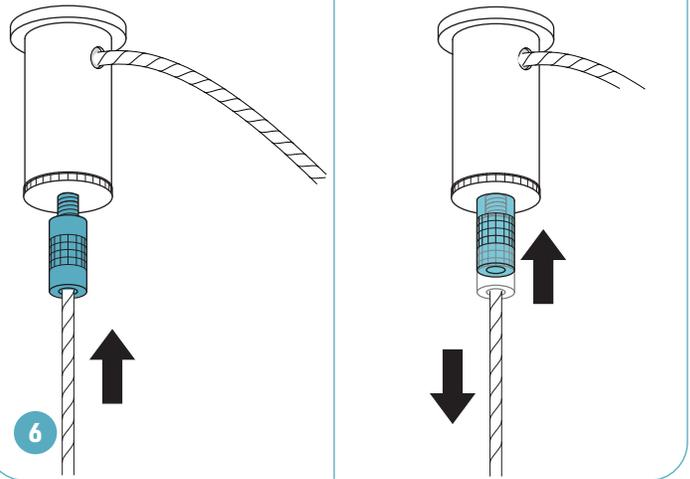
Resserrer les butées sur les fixations de câble (l). Couper l'excédent de câble.
