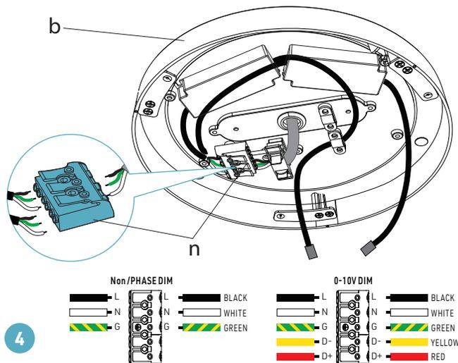
S'assurer que l'alimentation soit coupée à partir du panneau électrique. Localiser la boîte de jonction (i). Effectuer les connexions électriques entre le câble d'alimentation (j) et le luminaire.
