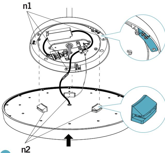
Assembler le luminaire (h) au boîtier de transfo (b) en le tournant dans le sens antihoraire pour les faire verrouiller et les positionner en place.
