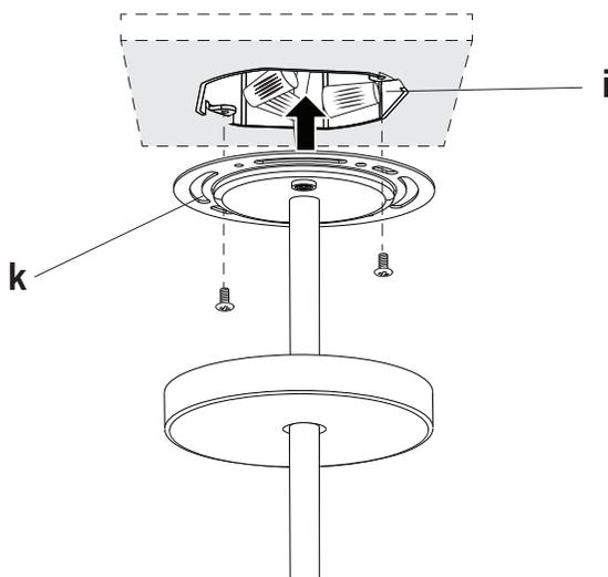
Faire glisser la canopée (d) jusqu'au support de montage (k) et la fixer à l'aide de l'aimant intégré.
