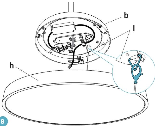
Faire la connexion des fils électriques du boîtier de transfo (b) et du luminaire (h) ainsi que la connexion des fils électriques du boîtier de transfo (b) et du dispositif d'éclairage vers le haut (g) à l'aide de connecteurs rapides (m1, m2).
