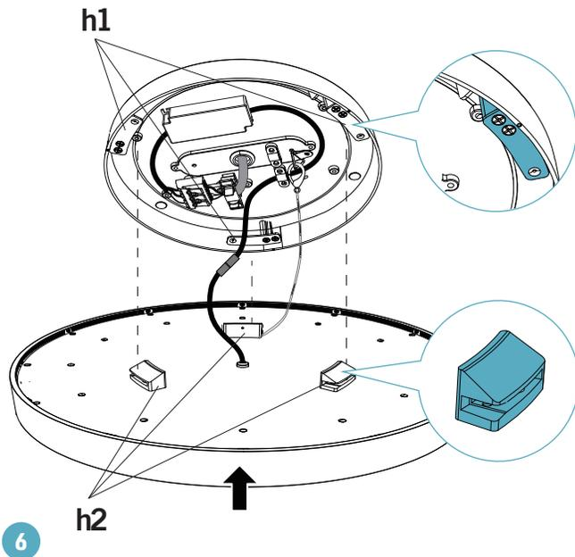
Assembler le luminaire (d) au boîtier de transfo (c) en le tournant dans le sens antihoraire pour les faire verrouiller et les positionner en place.
