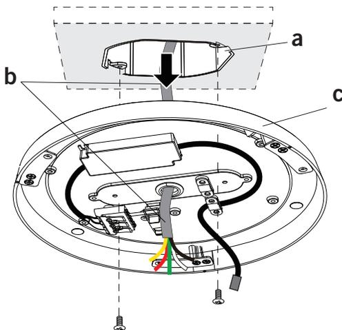
Effectuer les connexions électriques à l'aide des connecteurs électriques intégrés (n) à l'intérieur du boîtier du transfo (c) selon le type de gradateur (voir le schéma en bas).
