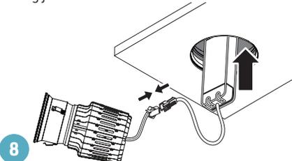
Pousser le module DEL dans le trou de montage et fixer le diffuseur dans le support sans bordure.
