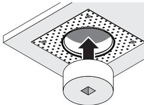
Utiliser du plâtre pour niveler les joints. Lorsque séché, apprêter et peindre. Retirer le protecteur du trou de montage.
