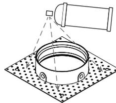
Insérer le support sans bordure dans le trou découpé et le fixer avec quatre vis à bois.
