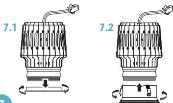
Connecter le module DEL au transformateur. Insérer le transformateur à travers le trou de montage et sécuriser sur les solives du plafond.
