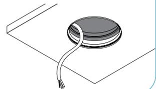
Dévisser et retirer l'anneau supérieur du module DEL. Visser le module DEL avec le diffuseur.
