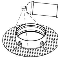
Insérer le support dans le trou découpé et le fixer avec quatre vis à tête plate (non fournies).
