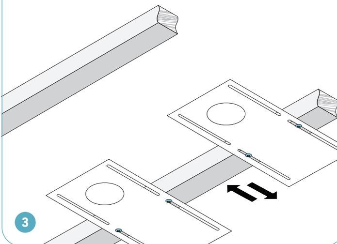
Serrer les vis. Procéder à l'installation des cloisons sèches.
