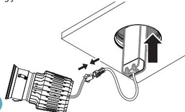
Pousser le module DEL dans le trou de montage et fixer le diffuseur dans le support sans bordure.
