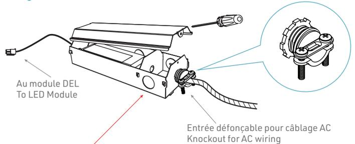
UTILISER LES ENTRÉES DÉFONÇABLES LATÉRALES POUR CÂBLAGE DE GRADATEUR 0-10V
