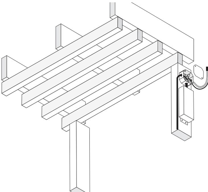
2. Installer le profilé Sulcus, utiliser des vis à cloison sèche pour fixer aux poutres murales et/ou aux solives de plafond. / *Install the Sulcus profile, use drywall screws to secure it to wall studs and/or ceiling joists.*
