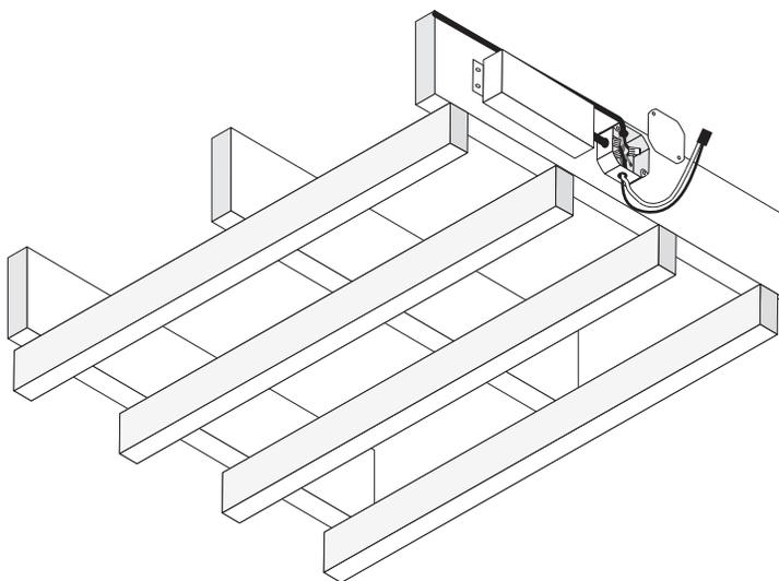
2. Installer le profilé Latus, utiliser des vis à cloison sèche pour fixer aux poutres murales et/ou aux solives de plafond. / *Install the Latus profile, use drywall screws to secure it to wall studs and/or ceiling joists.*
