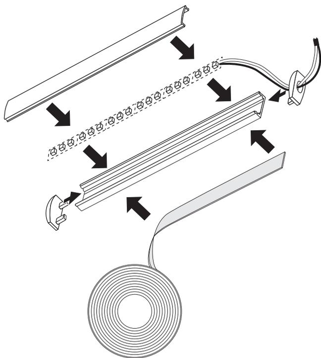
6. Installer l'assemblage DEL dans le canal d'éclairage du profilé Latus. / *Install the LED assembly in the light channel of the Latus profile.*
